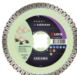
Tronçonnage à sec et à eau de grès céramique, dalle sur plot. Disque à couronne continue cannelée. Système XLOCK de montage sans clé. Hauteur diamantée optimisée pour une grande longévité.
