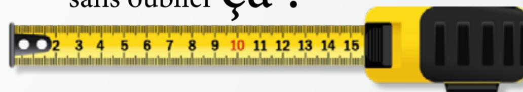
Les mètres rubans mesurent de 1 à 10 mètres, et sont constitués d'une lame d'acier graduée qui s'enroule automatiquement dans un boîtier en plastique ou en métal grâce à un ressort interne. La lame d'acier qui les constitue est incurvée, ce qui les rend rigides une fois déroulés, les plus robustes peuvent être utilisés verticalement jusqu'à plusieurs mètres sans support.
