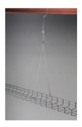
Double crochet permettant la fixation de chemins de câble ou de luminaires. Conception spéciale qui permet de défaire un crochet temporairement pour un entretien ou pour ajouter des câbles dans des chemins de câble. Stabilisation améliorée grâce à sa forme Y. Une fermeture ressort sécurise la connexion. Charge statique : 440 N.
