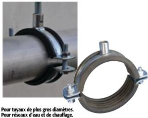
L'écrou de raccordement soudé en angle a des angles plats pour accueillir des clés. Bride facile à ouvrir pour des tailles de tuyau inférieures à 4 pouces. Réduction du bruit de catégorie II selon la norme DIN EN ISO 3822-1. Conforme à la conception d'isolation acoustique selon la norme DIN 4109. Température d'utilisation : -50 à +110°C.
