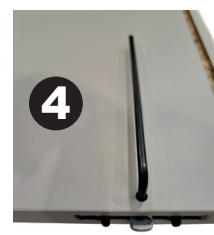
Partie mobile de l'assembleur position déverrouillée. (3) Partie mobile de l'assembleur position verrouillée. (4) Le verrouillage s'obtient via un quart de tour avec la clef allen dans le trou d'assemblage sur le panneau.
