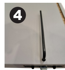
Partie mobile de l'assembleur position déverrouillée. (3) Partie mobile de l'assembleur position verrouillée. (4) Le verrouillage s'obtient via un quart de tour avec la clef allen dans le trou d'assemblage sur le panneau.
