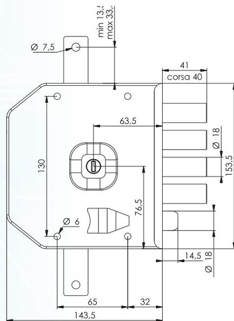
Serrure à appliquer pour porte, triple avec pêne, équipé de 4 pènes en acier. Avec clé intérieure et pompe-cylindre à clé poinçonnée extérieure.
