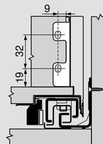
\* + 1 mm dans le cas de coulisses montées avant l'assemblage du corps de meuble
