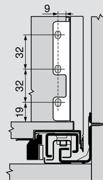
\* + 1 mm dans le cas de coulisses montées avant l'assemblage du corps de meuble
