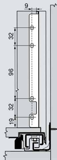
\* + 1 mm dans le cas de coulisses montées avant l'assemblage du corps de meuble
