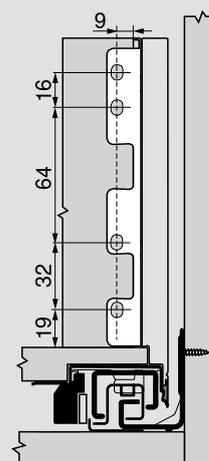
\* + 1 mm dans le cas de coulisses montées avant l'assemblage du corps de meuble
