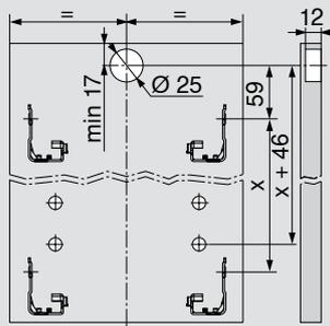
\* + 1 mm dans le cas de coulisses montées avant l'assemblage du corps de meuble
