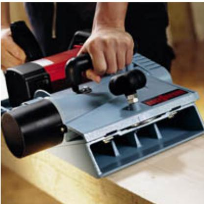
Système innovateur d'éjection des copeaux. Pour un tuyau flexible de 75/80 mm.
