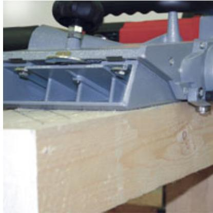
Rouleaux de butée – pour une utilisation maximale de la largeur de rabotage.
