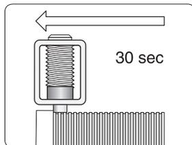
En avançant plus vite, vous donnerez plus d'"attaque" à la meule. Traversez en 30 secondes, avec une passe maximale de 0,25 mm.
