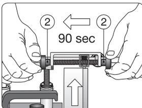
Démarrez, et faites avancer la pointe en tournant alternativement les molettes (2). La traversée doit durer environ 90 secondes.
