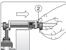
Arrêtez la machine. Déplacez l'outil avec l'un des boutons (2) de telle sorte qu'il soit à l'extérieur de la meule.
