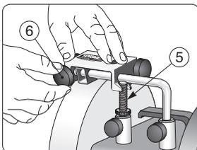
Appuyez sur le redresseur en direction du pied (5). Serrez le bouton de verrouillage.
