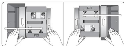
**Remarque** Si vous possédez une ancienne machine avec support universel sans réglage de précision, réglez la profondeur à la main.
