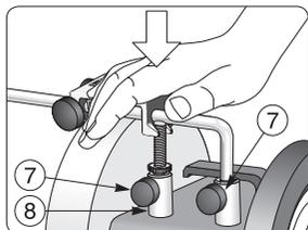
Pressez vers le bas de telle sorte que le réglage de précision prenne appui sur la douille (8). Verrouillez avec les boutons (7).
