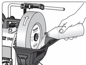
Démarrez la machine et remplissez le bac d'eau.
