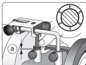
Réglez la profondeur de coupe voulue (a) en remontant le réglage de précision gradué tous les 0,25 mm.
