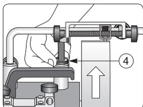
Descendez le support universel avec le réglage de précision (4) jusqu'à ce que l'outil touche le point le plus haut de la meule.
