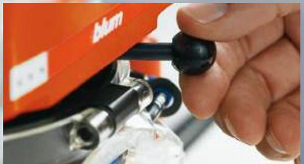
Avec la tête de perçage pivotante multibroches vous pouvez régler, sans outil, avec précision et rapidement différents schémas de perçage pour meubles.
