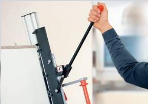
Grâce à cette technique, un minimum de force suffit pour l'assemblage par ergots des côtés et du fond de tiroir. La construction ergonomique de BOXFIX PRO permet de travailler en position droite.
