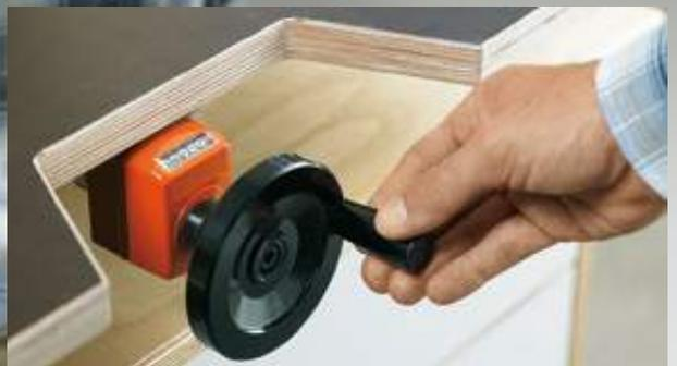
La cote de perçage est réglable de manière exacte grâce à la manivelle et l'affichage numérique.
