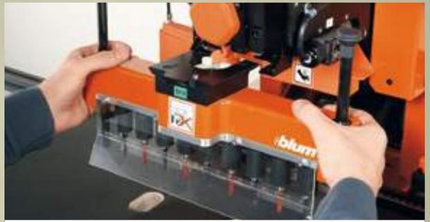
La tête de perçage équipée possède un codage couleurs et, après mise en place, est maintenue sans outil à l'aide d'une poignée de serrage.
