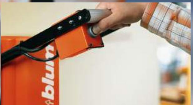
Le levier de serrage est déplacé manuellement vers le bas pour un perçage précis.
