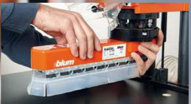
La tête de perçage 9 broches pour ligne de trous entraxe 32 mm, et la tête de perçage à 8 broches pour attache-façades et coulisses corps de meuble permettent un usinage très précis.
