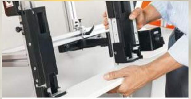
Le réglage des hauteurs et des largeurs du dos est variable. Vous avez la possibilité de pré-régler des positions récurrentes avec une butée de largeur supplémentaire.
