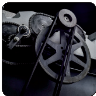
Entraînement des rouleaux par chaîne. Entraînement moteur à double courroie. Aandrijving van rollen via schakelketting. Aandrijving van motor met een dubbele riem
