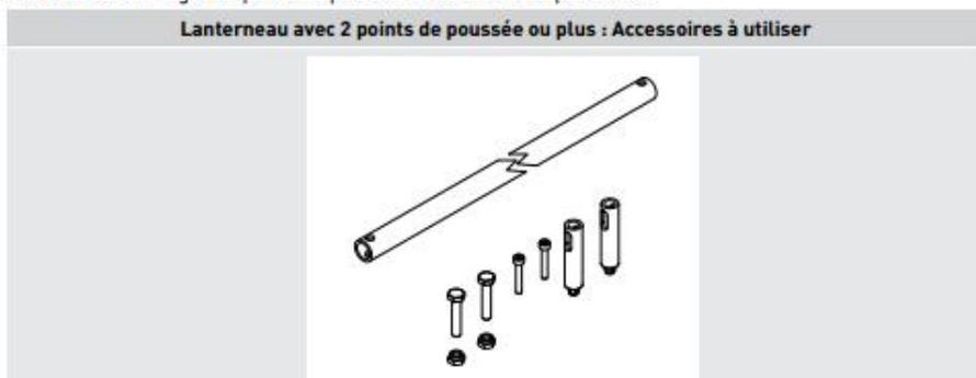
Si l'entraxe « In » entre les points de poussée est différent de celui indiqué dans le tableau suivant, utiliser la barre de mesure supérieure à l'entraxe et l'adapter pour la mesure requise.
