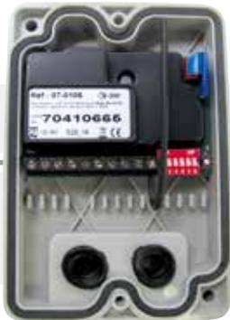
07-0106 Récepteur HF ECO avec antenne intégrée, 2 relais,
