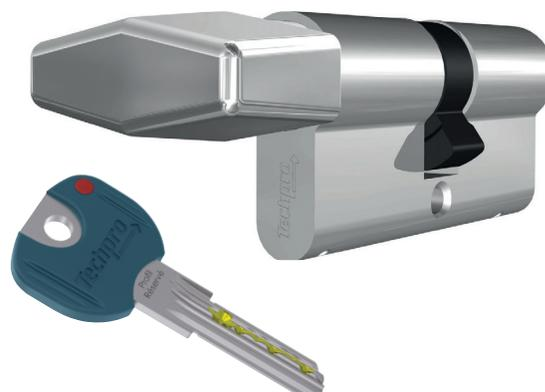
**Version LM6 Anti-effraction stock B :** En plus d'être débrayable (type 2 entrées), l'intégralité des cylindres est équipée de la fonction «SNAPP» (rupture programmée sur l'avant du cylindre). Les 2 côtés sont usinés pour les types 2 entrées. Fourni avec 3 clés set carte de sécurité.
