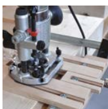
Usinage avec gabarit
