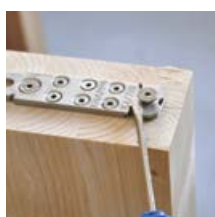
Montage de la goupille de verrouillage
