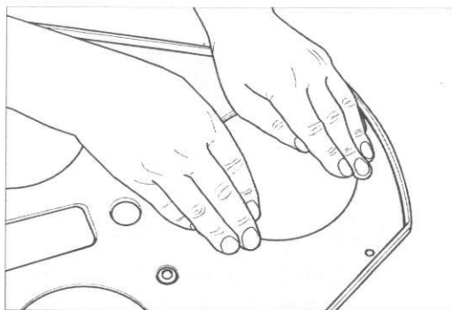
Fig. 56 Comprimez régulièrement le joint, notamment sur le bord et dans la zone des logements de plateaux de disque.
