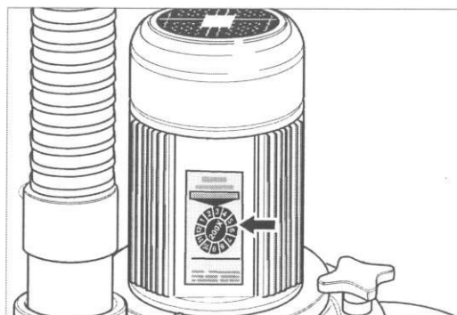
Fig. 58 Le sigle de contrôle sur le moteur indique la prochaine date de révision.
