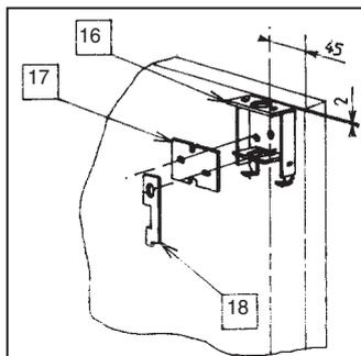
Positionner la contre-plaque de fixation du boîtier haut -16- à 2 mm du haut de la porte, en faisant coïncider les V de positionnement avec l'axe -1- et pointer la position des 2 vis de fixation.
