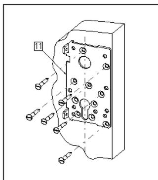
Présenter la contreplaqué **-11-** et faire coïncider les V de positionnement avec les axes **-1-** et **-2-**. Fixer la contreplaqué **-11-** à l'aide des 6 vis VBA FZ5x30 et contrôler sa position par rapport aux V de positionnement.
