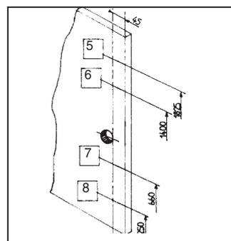
3-1 Si la hauteur de la porte ne dépasse pas 2190 mm, tracer 4 axes horizontaux **-5-** **-6-** **-7-** **-8-** respectivement à 250-660-1400-1825 mm du bas de porte.
