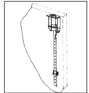
par l'intermédiaire des vis autota-raudeuses 4x8 sous les tringles -
