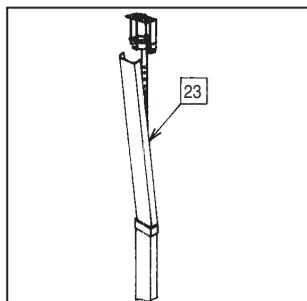
Serrer la vis dans le boîtier haut tout en maintenant la butée du cache tringle en appui sur le cache tringle.
