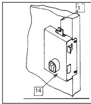
Mettre en place provisoirement le mécanisme central **-14-** et tracer le contour de la têtère sur le chant de la porte.
