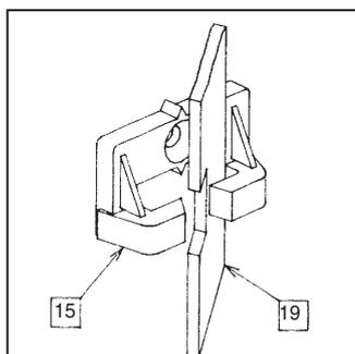
Passer la tringle -19- au niveau de son encoche dans le guide tringle, et effectuer une légère rotation pour la positionner et la faire coulisser, afin de l'accrocher au niveau de la tringle du mécanisme central.
