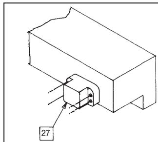
Positionner au ras du bâti le renfort de gâche haute -27- dans l'axe du pêne haut. Le fixer par l'intermédiaire des 4 vis VBA RZ 5x50.
