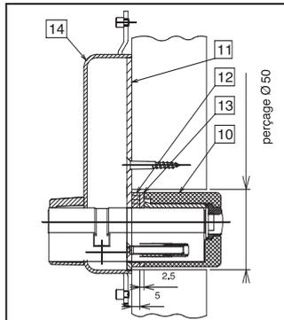
Le vissage sera facilité en lubrifiant les filets des 4 vis à métaux Ø5. Important : serrer jusqu'au blocage.
