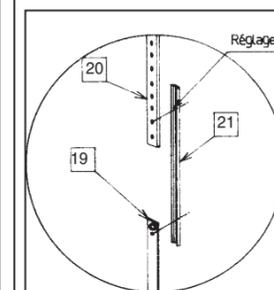
Régler et fixer l'attache tringle -21- par l'intermédiaire des vis autotaraudeuses 4x8 sous les tringles -19- et -20- Chercher la position la plus appropriée pour que le pêne se situe au bord de la porte. Attention le pêne du mécanisme central doit être rentré. Procéder de manière identique pour la partie basse.
