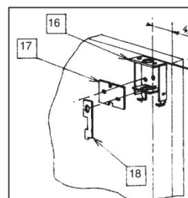
Positionner la contre-plaque de fixation du boîtier haut -16- à 2 mm du haut de la porte, en faisant coïncider les V de positionnement avec l'axe -1- et pointer la position des 2 vis de fixation.
