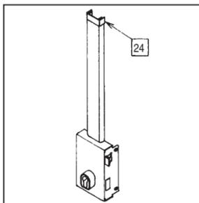
Attention à la peinture. Utiliser des «Mordaches». Mettre en place un raccord de cache tringle -24- et venir mettre en place le cache tringle coupé.
