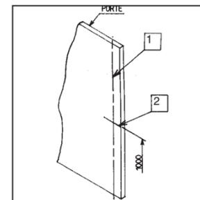
Tracer 1 axe vertical -1- à 45 mm du bord, de haut en bas, et un repère -2- sur le chant de la porte à 1000 mm du bas.
