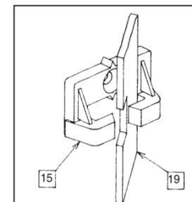
Passer la tringle -19- au niveau de son encoche dans le guide tringle, et effectuer une légère rotation pour la positionner et la faire coulisser, afin de l'accrocher au niveau de la tringle du mécanisme central.
