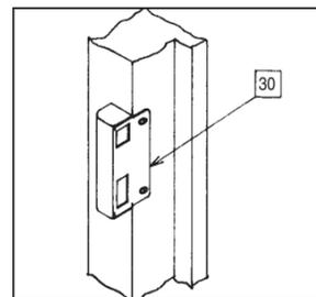
Positionner la gâche centrale -30- dans l'alignement du mécanisme central et tracer le contour de la tête. Entailler le bâti sur une profondeur de 2 mm
