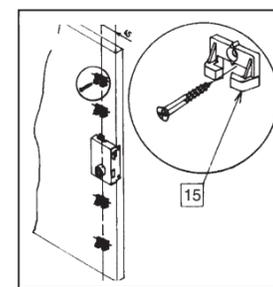
Fixer les 4 guides tringles -15- à l'intersection des axes -5- -6- -7- -8- et -1-. à l'aide des 4 vis VBA 4x20
