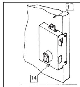
Mettre en place provisoirement le mécanisme central -14- et tracer le contour de la têtère sur le chant de la porte.
