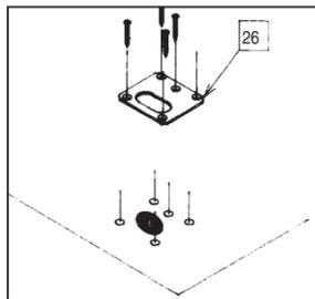
Tracer le contour du boîtier bas sur le sol. Aligner la gâche -26- sur le tracé et repérer la position des 4 trous de fixation et du passage de pêne.
