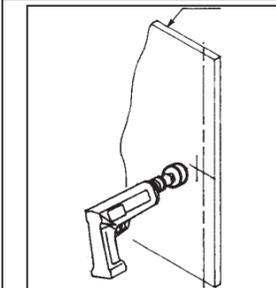
En cas de montage d'une double béquille, percer un trou Ø12 traversant.
