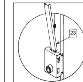
Placer un cache tringle -23- au niveau du mécanisme central, et effectuer une légère pression sur celui-ci pour venir le clipser sur le guide tringle.
