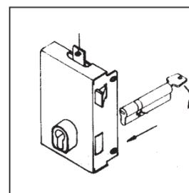
A l'aide de la clef, aligner le panneton avec le barillet et l'introduire par l'intérieur dans le mécanisme central, côté rallongé vers l'extérieur.
