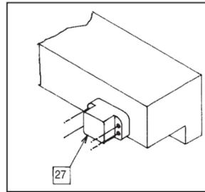
Positionner au ras du bâti le renfort de gâche haute -27- dans l'axe du pêne haut. Le fixer par l'intermédiaire des 4 vis VBL 5x50.
