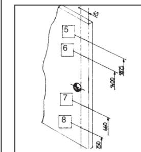
3-1 Si la hauteur de la porte ne dépasse pas 2190 mm, tracer 4 axes horizontaux -5- -6- -7- -8- respectivement à 250-660-1400-1825 mm du bas de porte.
