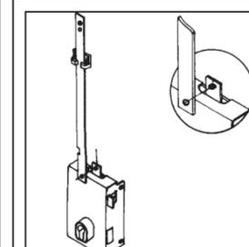
Passer la tringle -20- au niveau de son encoche dans le guide tringle. Effectuer une légère rotation pour la positionner et la faire coulisser, afin d'introduire le pêne dans le boîtier haut.
