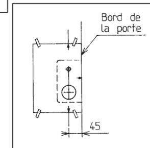
Dès que le gabarit est correctement positionné, le fixer sur la porte à l'aide d'un ruban adhésif.
