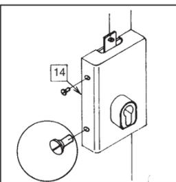
Mettre en place le mécanisme central -14- sur la contre plaque et le fixer par l'arrière par l'intermédiaire des 2 vis épaulées M5x15. Fixer le mécanisme central par l'intermédiaire des 2 vis VBA 5x20 mm.
