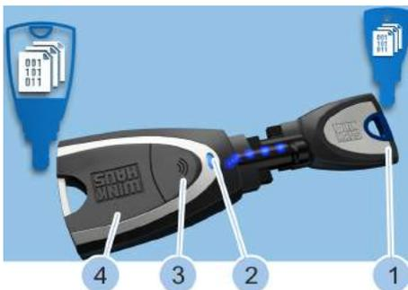
Fig. 8: Lire les données d'une clé passive
