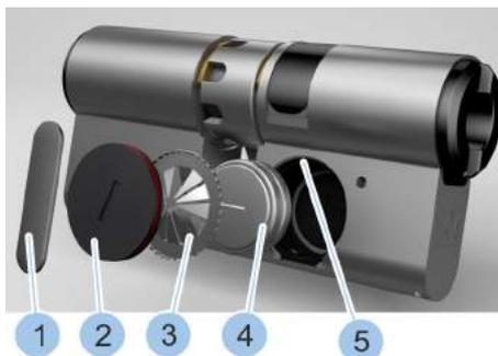
Fig. 83: Insérer les piles
