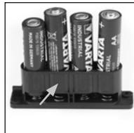
Remettez le chariot avec les batteries dans l'électronique de verrouillage et serrez les vis.
