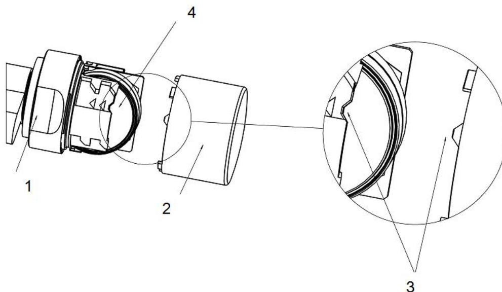
9. Seulement pour les cylindres MH : Arrêter à nouveau l'antenne en l'enclenchant.
