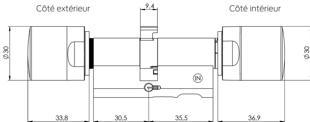
DoorMonitoring - Demi-cylindre - Actif (DM HZ)
