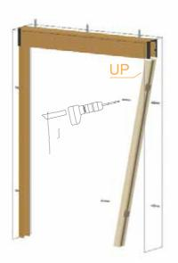
Détachez la bande adhésive du guide inférieur et la placer dans l'axe des profils.
