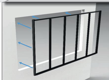
Le support de pose de la verrière doit être au niveau, d'équerre et rectiligne
