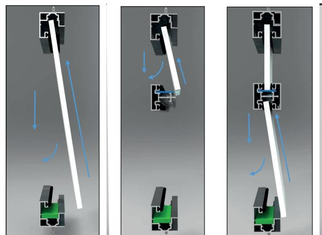
Enfiler le verre dans le cadre horizontal haut et le laisser reposer sur les cales
