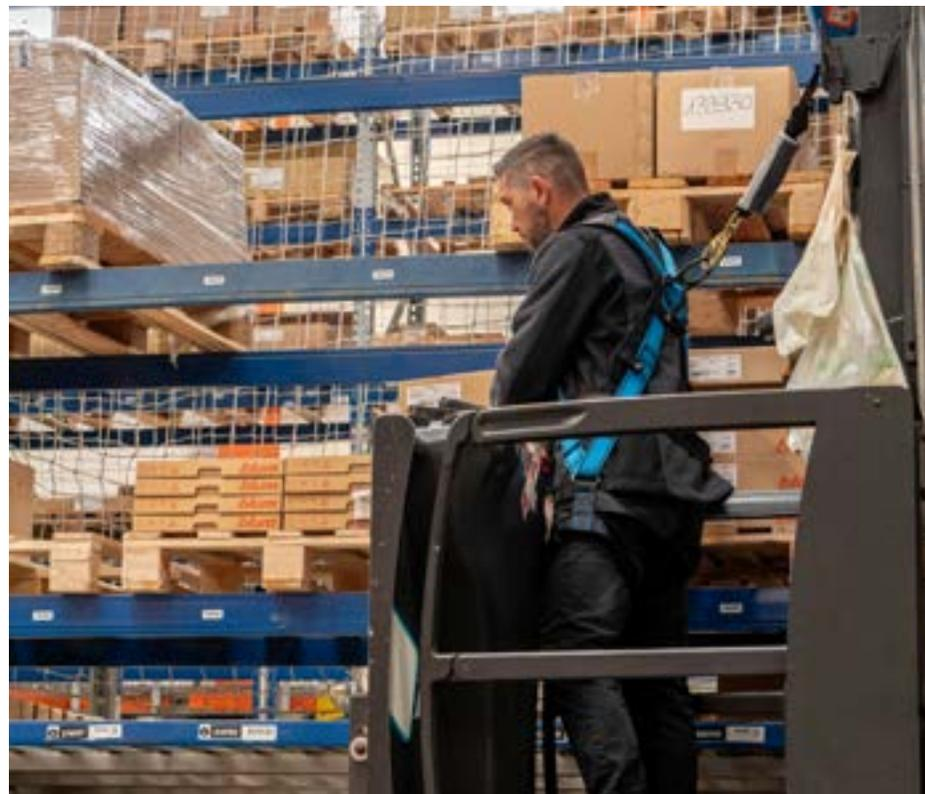
Les collaborateurs amenés à utiliser les chariots préparateurs de commande à poste élévable, portent des harnais afin de garantir leur sécurité en cas de chute.
